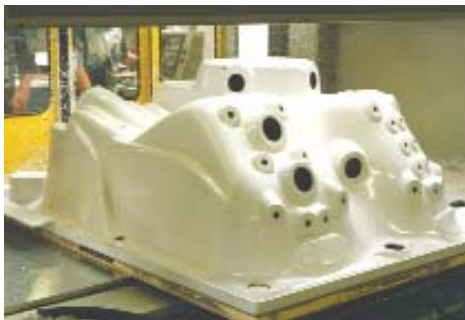
PRÄZISE Zuschnitte und Bohrungen werden mit modernen CNC-Fräsen erstellt.
